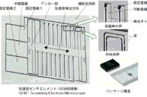
加速度センサー 三菱電機(株) 先端技術総合研究所
